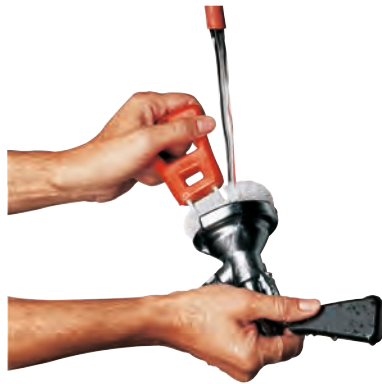
Abbildung 27: Reinigung einer Zapfarmatur
