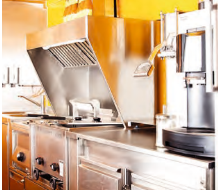
Abbildung 2: Glatt polierte Edelstahlfläche als Beispiel für eine leicht zu reinigende, desinfizierbare Arbeitsfläche.
