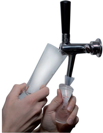
Abb. 2: Spülen des Hahnauslaufes und der Luftbohrung mittels Reinigungsball
